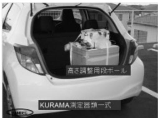
図1 KURAMA-II を搭載した車の後部
